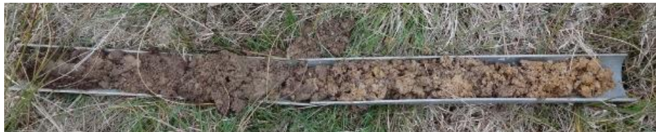
Figure 6 : Exemple d'une carotte de terre réalisée suite à un sondage
