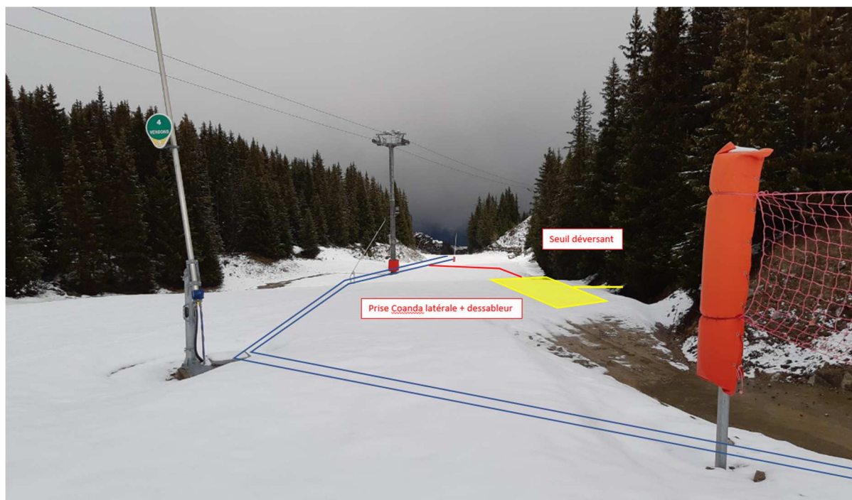
Figure 5 – Schéma de principe de la prise d'eau
