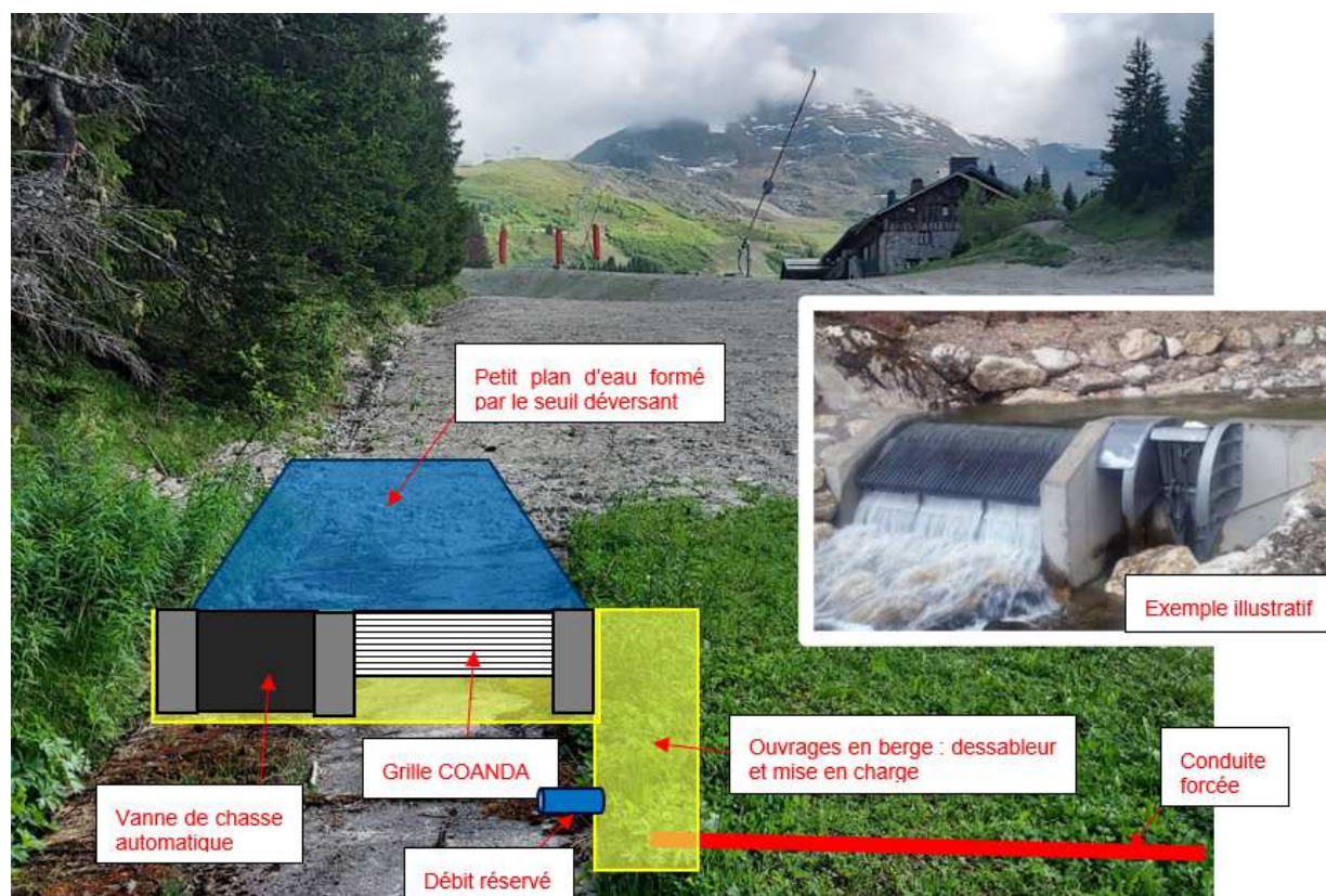
Figure 6 : Schéma de pré-implantation de la prise d'eau
