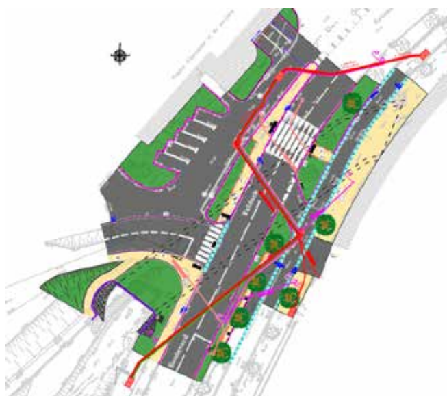
Figure 4 : Détail de la reprise de l'étonnement du Janon sous le boulevard Waldeck Rousseau et raccord à la voirie en projet
