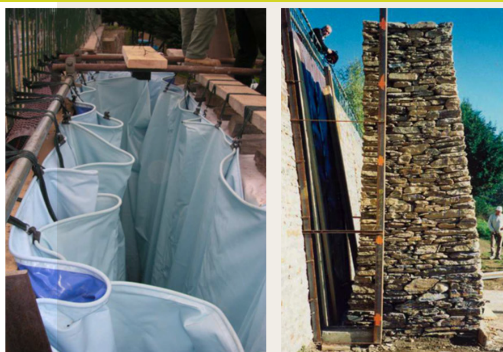
Le mur est chargé par une bache remplie d'eau, modèle simplifié du chargement d'un remblai © Boris Villemus, ENTPE – Ecole des Ponts ParisTech
