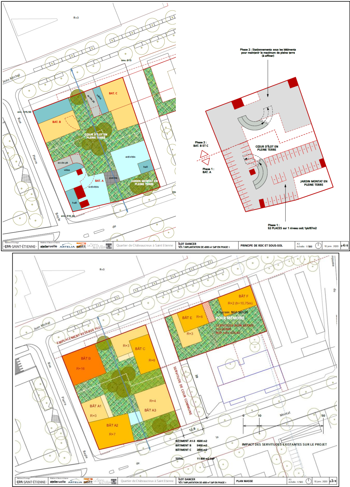
Figure 5: Plan de masse (haut) et principe de RDC et sous-sol partie ouest (bas) du projet. Source : EPASE.
