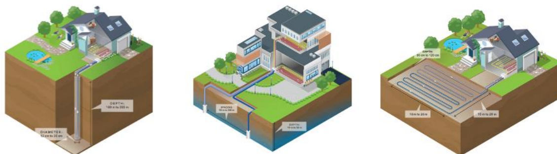
Figure 19 : Principaux dispositifs de captage associés aux pompes à chaleur géothermiques (captages sur sondes géothermiques verticales, captage sur nappe, captage horizontal) source : BRGM FEDER
