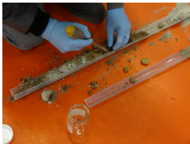
Prise d'échantillons provenant d'un carottage avant analyse en laboratoire
