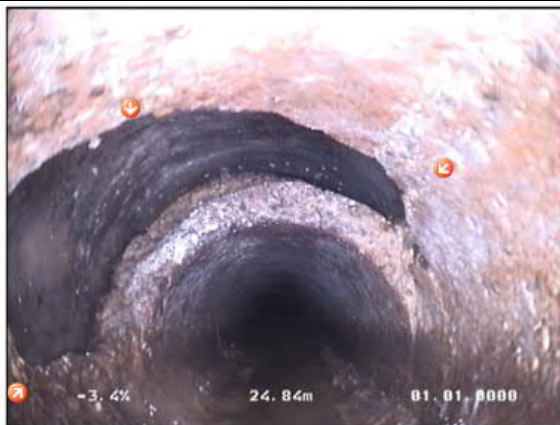
Photo: 35_35_102_A.JPG 25m, Réparation ponctuelle, étanchéité incertaine
