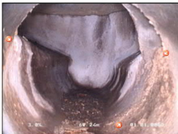
Photo: 12_12_34_A.JPG 62,6m, Concrétions de 08 à 04 h (jonction regard/canalisation, infiltrations)
