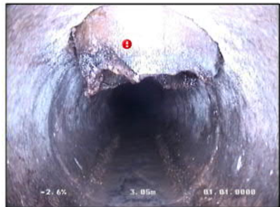
Photo: 51_51_160_A.JPG 3,4m, Raccordement pénétrant à 12 h.
