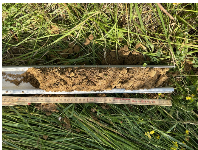
Figure 3: Carottage correspondant au sondage n°1 (eCKo, 2023)
