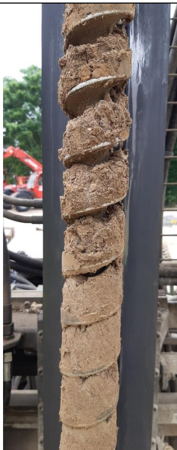
Vues des matériaux rencontrés et échantillonnés en S6 de 0,4 à 0.7m
