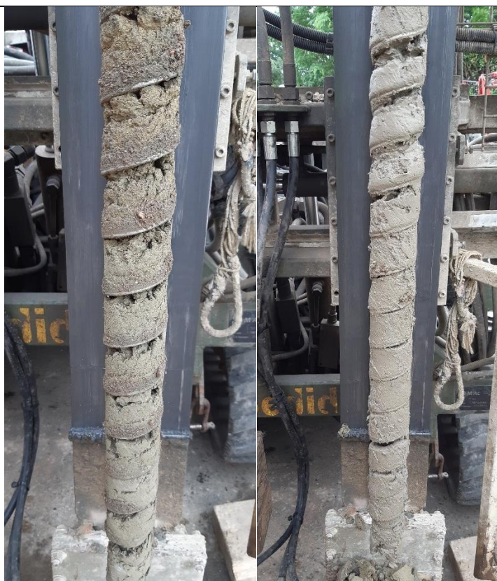
Vues des matériaux rencontrés et échantillonnés en S5 de 0,75 à 1m et de 2,5 à 3m
