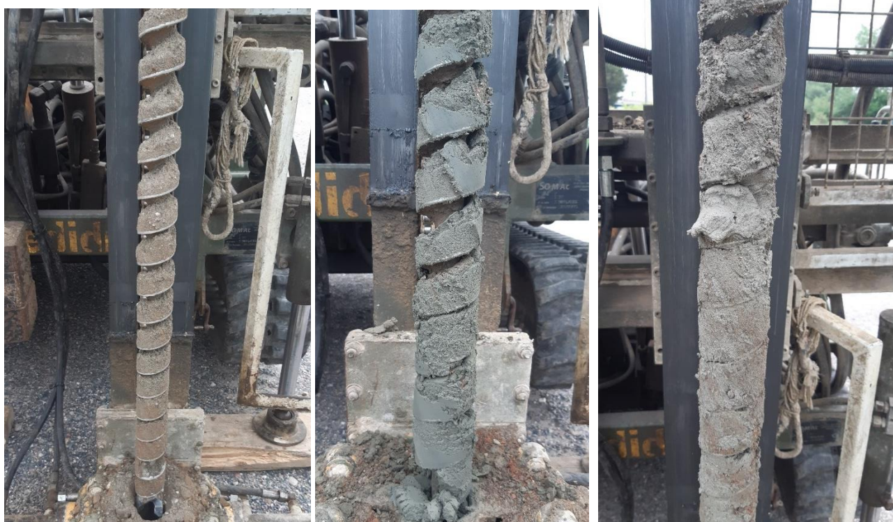
Vues des matériaux rencontrés en S2 de haut en bas et de gauche à droite : 0,2 à 1,5m ; 3 à 4,5 et 4,5 à 5m - échantillonné
