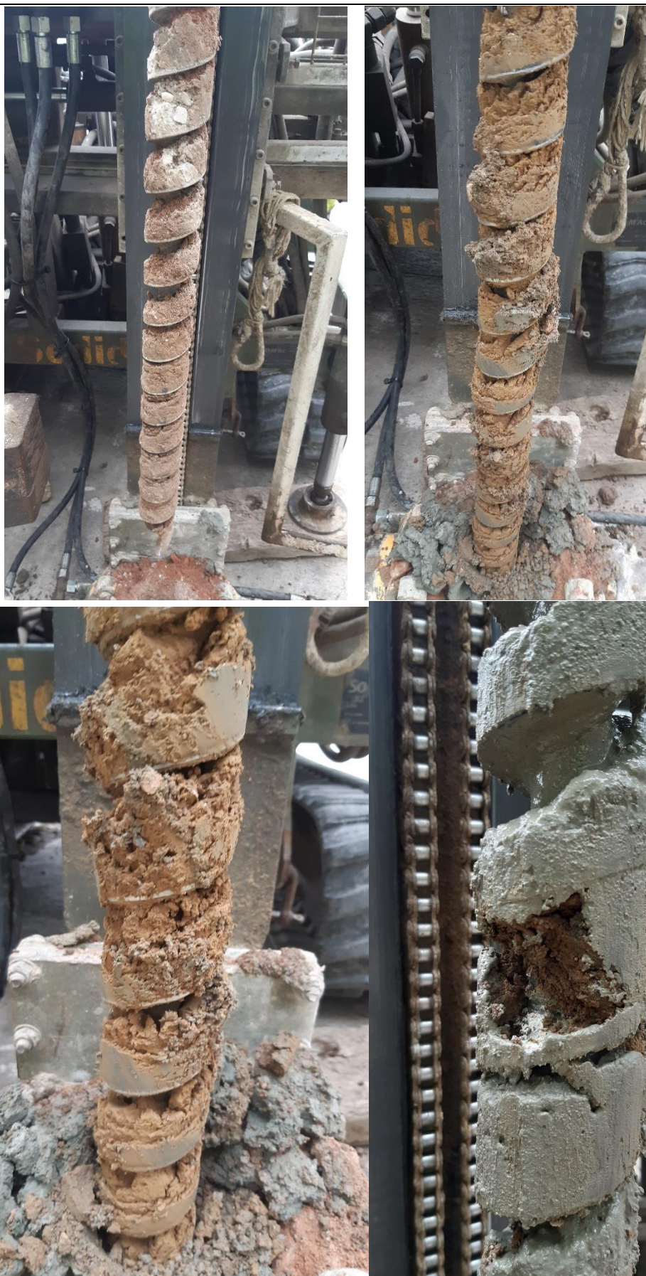
Vues des matériaux rencontrés en S3 de gauche à droite : 0,2 à 1,5m ; 1,5 à 3m ; 3 à 4,5m et de 4,5 à 5m - échantillonné
