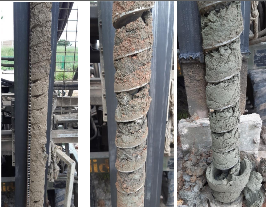
Vues des matériaux rencontrés en S4 0,2 à 1,5m – échantillonné puis de 1,5 à 3m et de 3m à 4,5m
