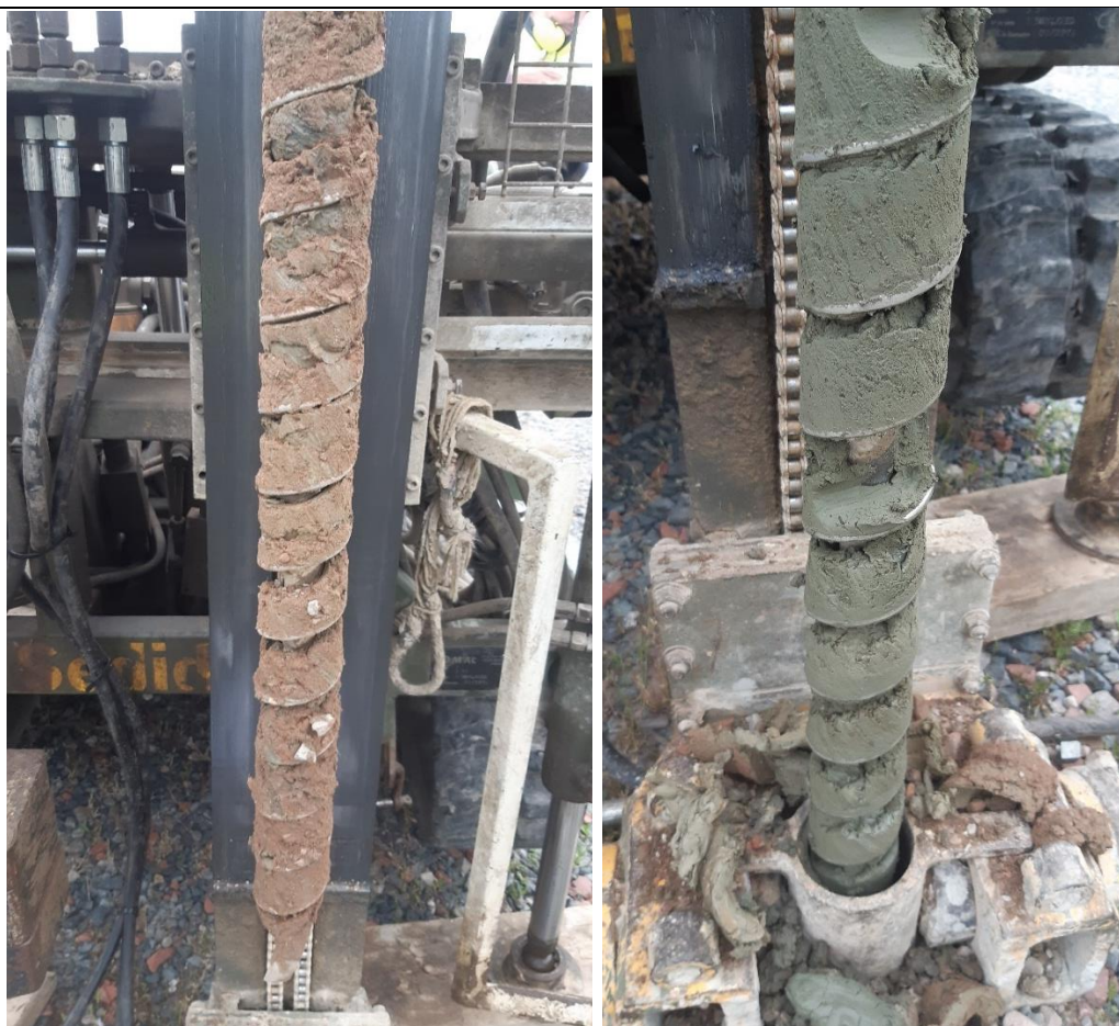
Vues des matériaux rencontrés en S1 de (gauche à droite) 1 à 1,5m - échantillonné et de 4 à 5m,
