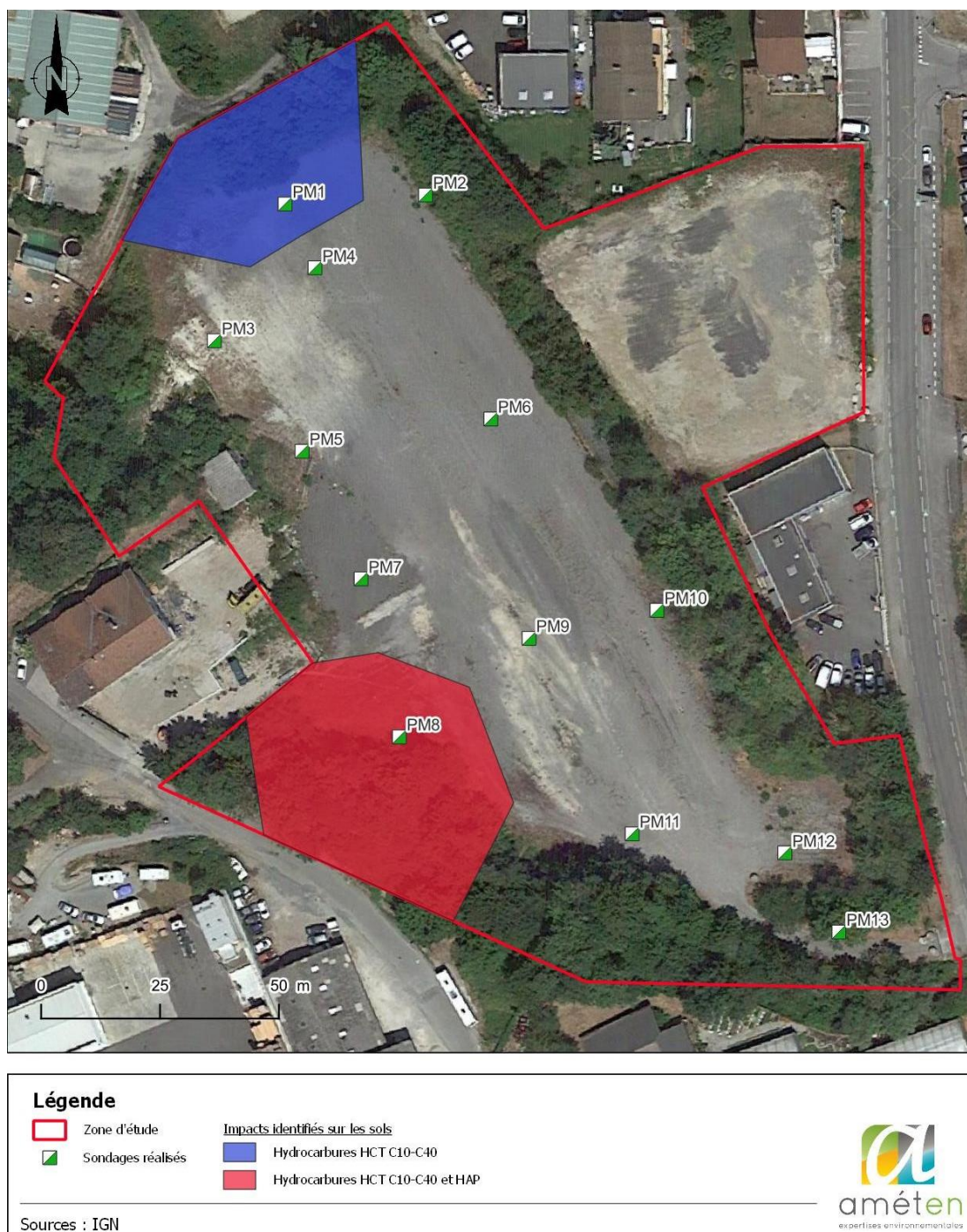
Figure 45 : Impacts identifiés sur les sols - interpolation sur la base de la densité de sondage réalisés (Source : Amétén, octobre 2023)
