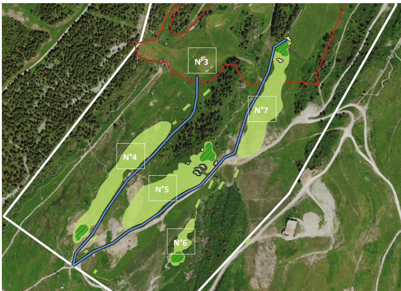
SCHEMA DE PRINCIPE – POSITION DE LA CANALISATION PRINCIPALE D'IRRIGATION (EN BLEUE) DU FUTUR GOLF
