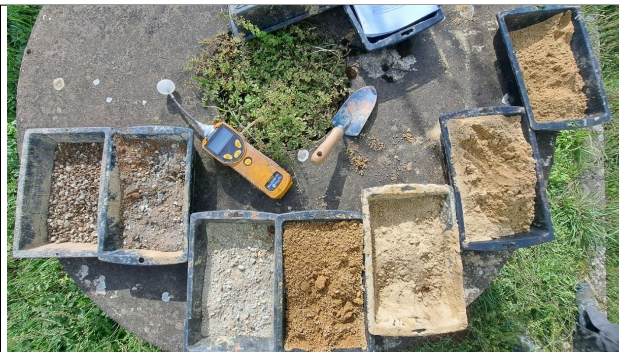
Fig. 8 - Exemple de relevé de cutting, de la surface vers le fond, réparti de gauche à droite. Le photoioniseur indique l'horizon de prélèvement, (plus forte concentration de gaz d'hydrocarbures et couleur grise légère).
