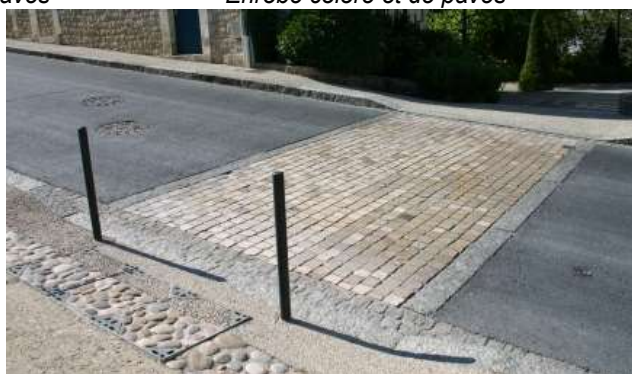
Exemple : utilisation de galet, dalles et béton désactivé
