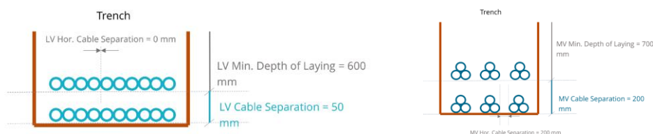
Caractéristiques et coupes transversales simplifiées des tranchées
