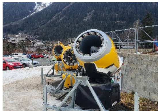
Enneigreur de type monofluide, "ventilateur"
