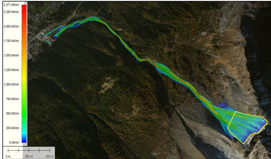
Figure 26 – Vue globale d'une modélisation dense coulante à l'échelle du versant – Carte des intensités avalancheuses
