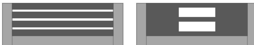
Schémas illustratifs : clôtures avec muret de 0,5 m, avec panneau présentant un dispositif ajouré de 30% de vide sur leur emprise
