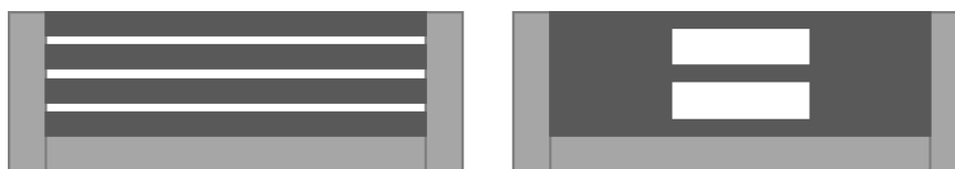
Schémas illustratifs : clôtures avec muret de 0,5 m, avec panneau présentant un dispositif ajouré de 30% de vide sur leur emprise
