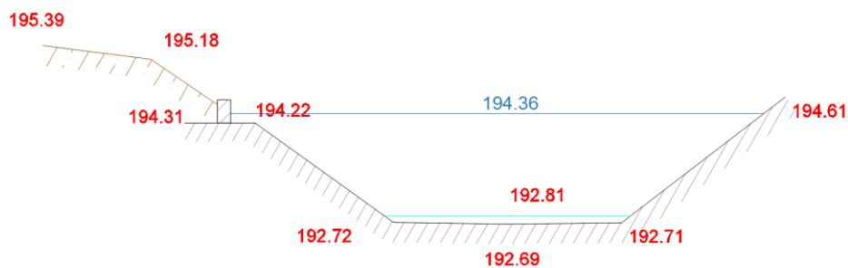
Figure 30 : Réhausse parapet PK 1150
