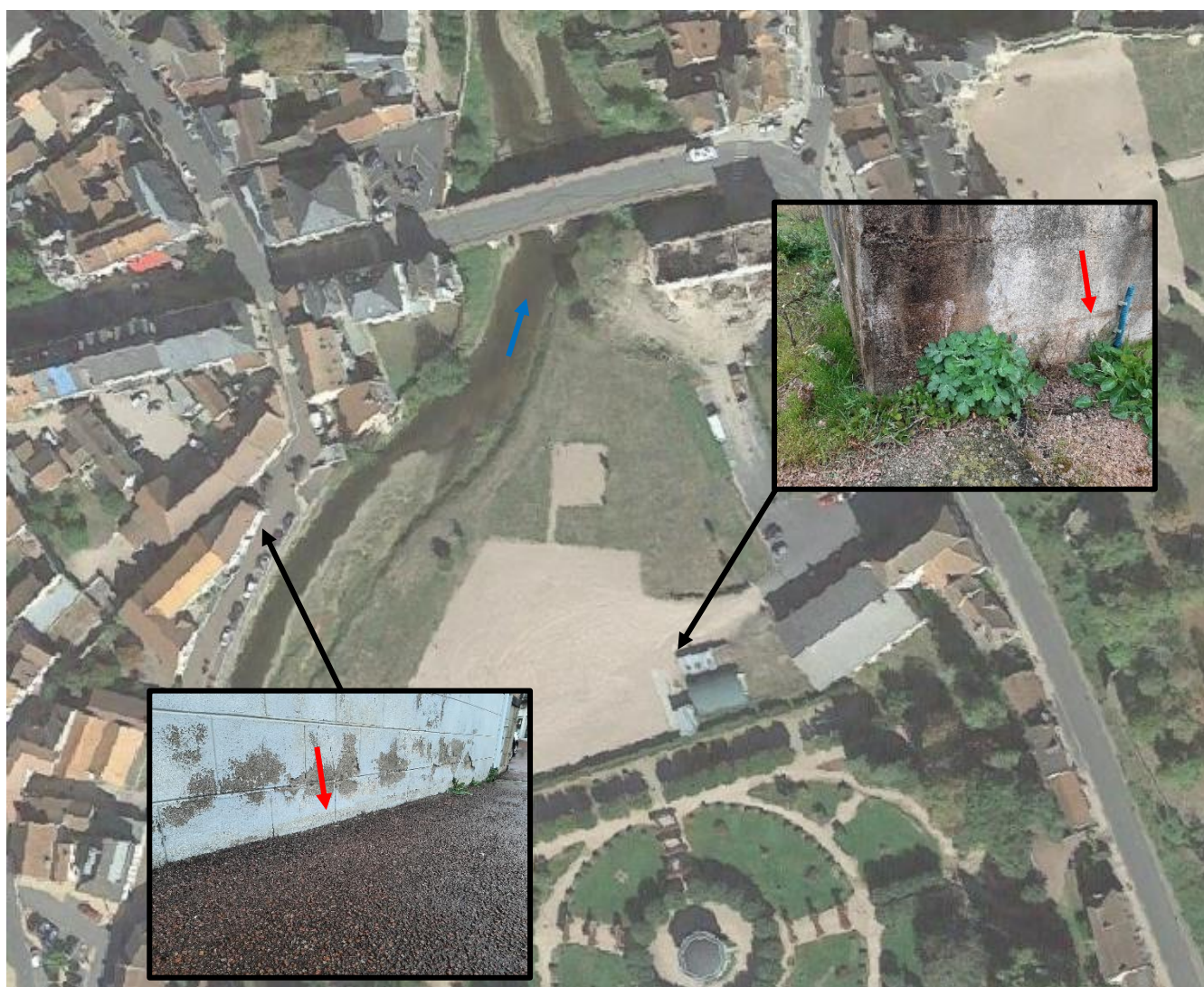
Figure 7 : Exemple de laisse de crue identifiée lors des investigations de terrain sur la place de Lapalisse
