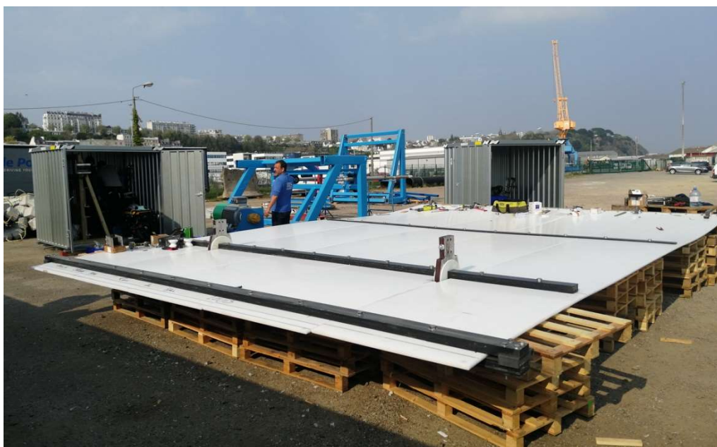
Figure 19 – Membrane du système 30 kW avant installation sur le site de Brest
