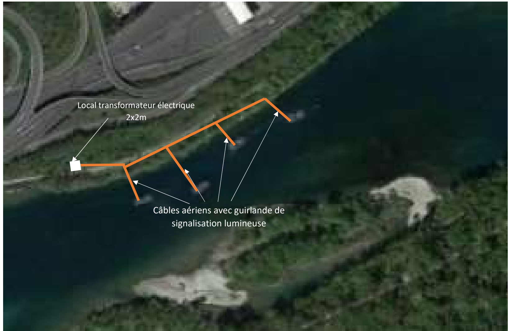
Figure 7 – Vue du dessus du raccordement électrique de la barge jusqu'au local électrique
