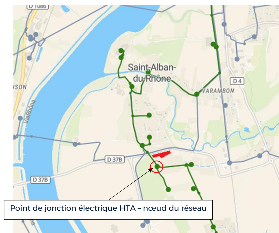
Figure 10 - Réseau électrique local, point de raccordement HTA.
