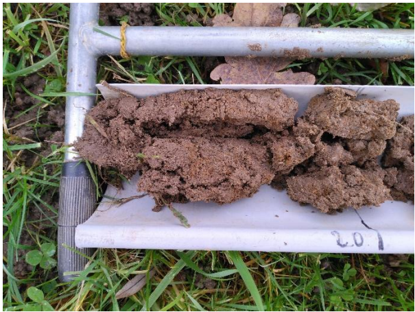
Photographie 9 : Sondage pédologique 2 et traces d’hydromorphie dès la surface (source : EODD©)
