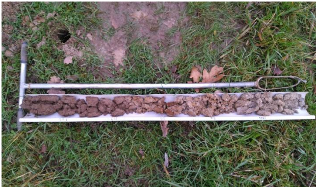
Photographie 9 : Sondage pédologique 2 et traces d’hydromorphie dès la surface (source : EODD©)
