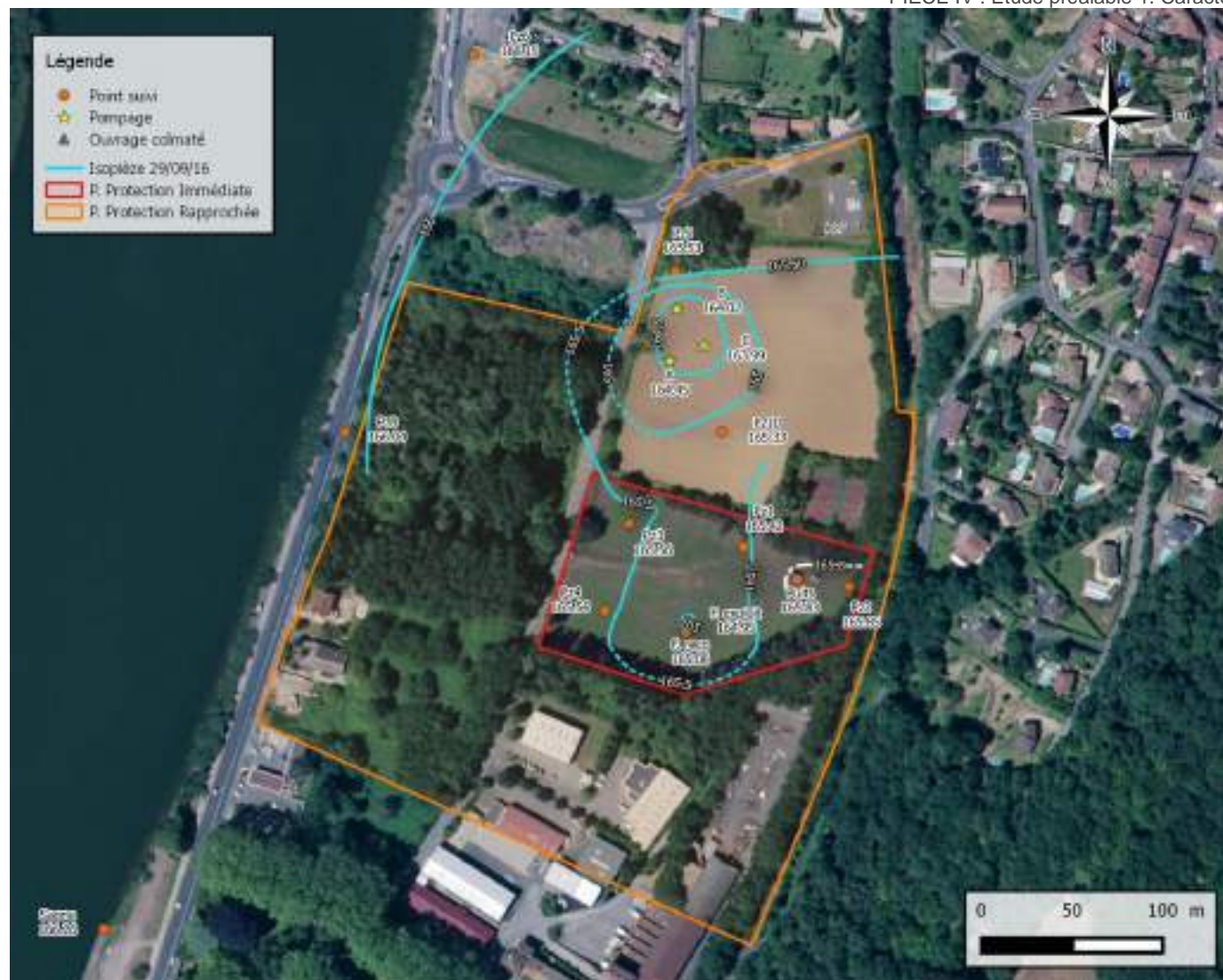
Figure 60 : Carte piézométrique en dynamique après 10 jours de pompage sur le forage d'exploitation et les trois forages d'essai – septembre 2016
