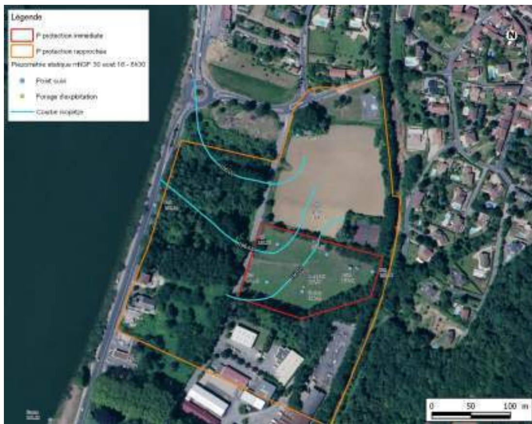
Figure 57 : Carte piézométrique du 30/08/16 vers 8h30 avant le démarrage de l'essai de pompage
