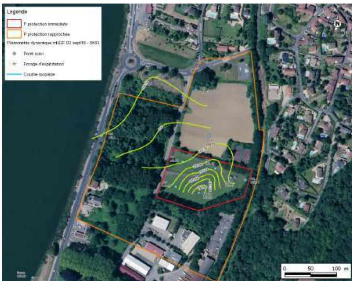
Figure 58 : Carte piézométrique après 72h de pompage sur le forage à 100 m 3 /h en septembre 2016 (REAUCE02192)
