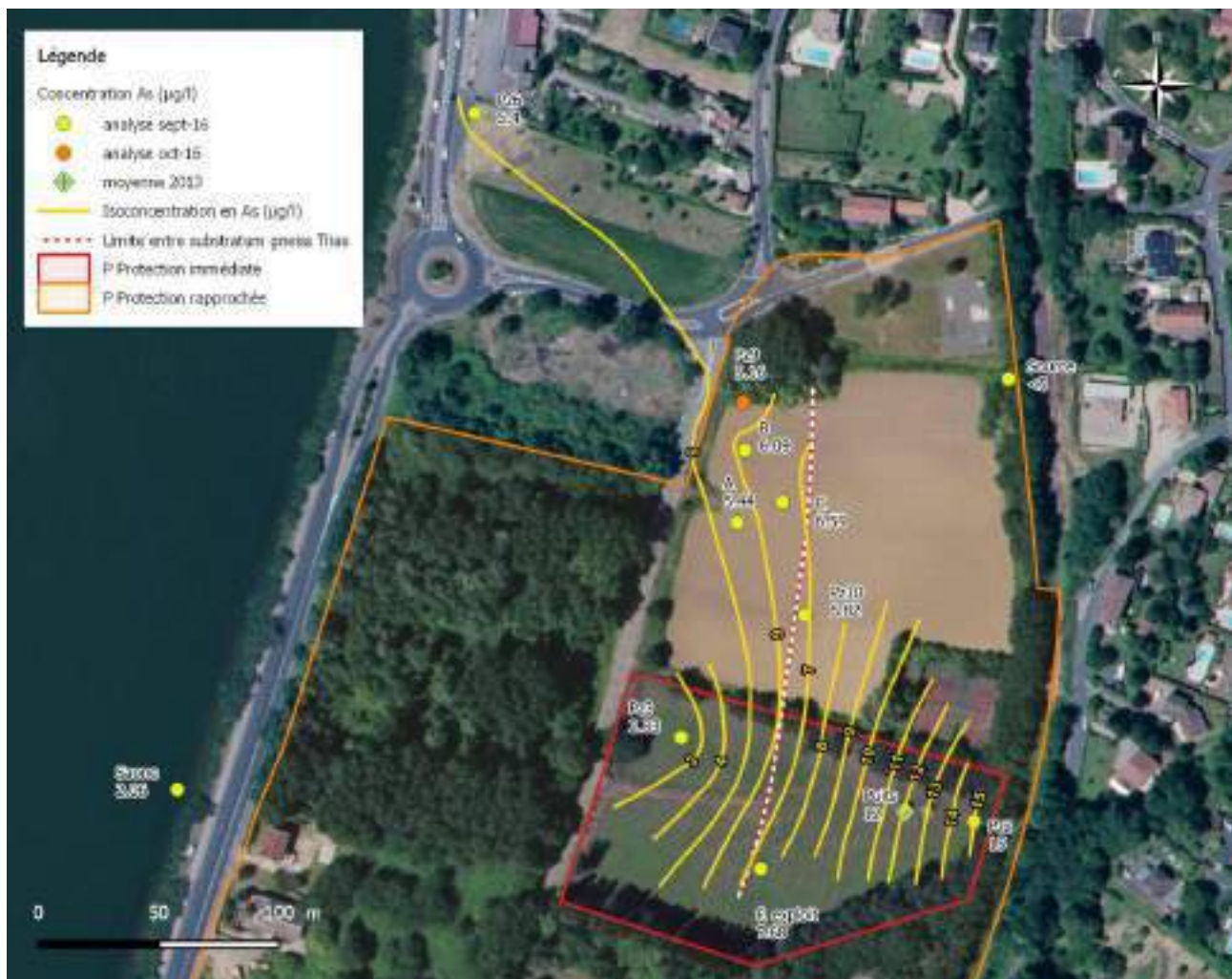
Figure 63 : carte des iso-concentrations en arsenic en fin d'essai de pompage
