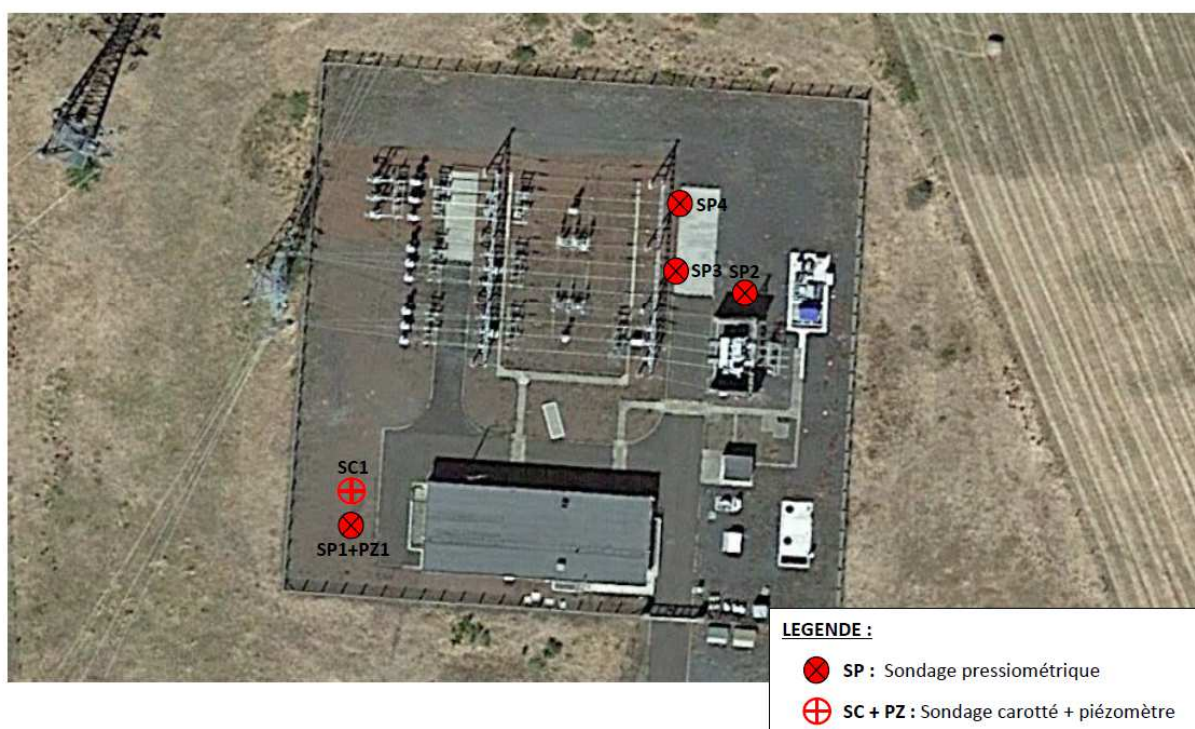
Figure 5 : Plan d'implantation des sondages (Etude géotechnique JUIN 2024)
