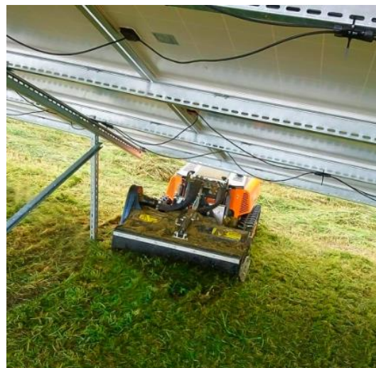
Exemple de broyeur et de robot tondeur utilisés pour l'entretien mécanique des couverts enherbés
