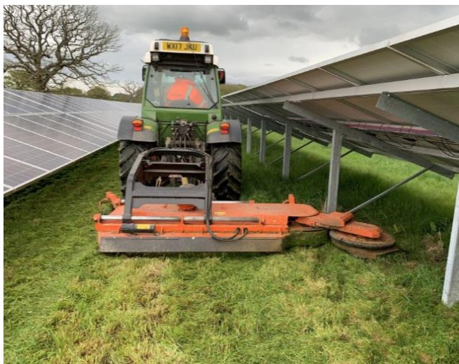
Exemple de broyeur et de robot tondeur utilisés pour l'entretien mécanique des couverts enherbés
