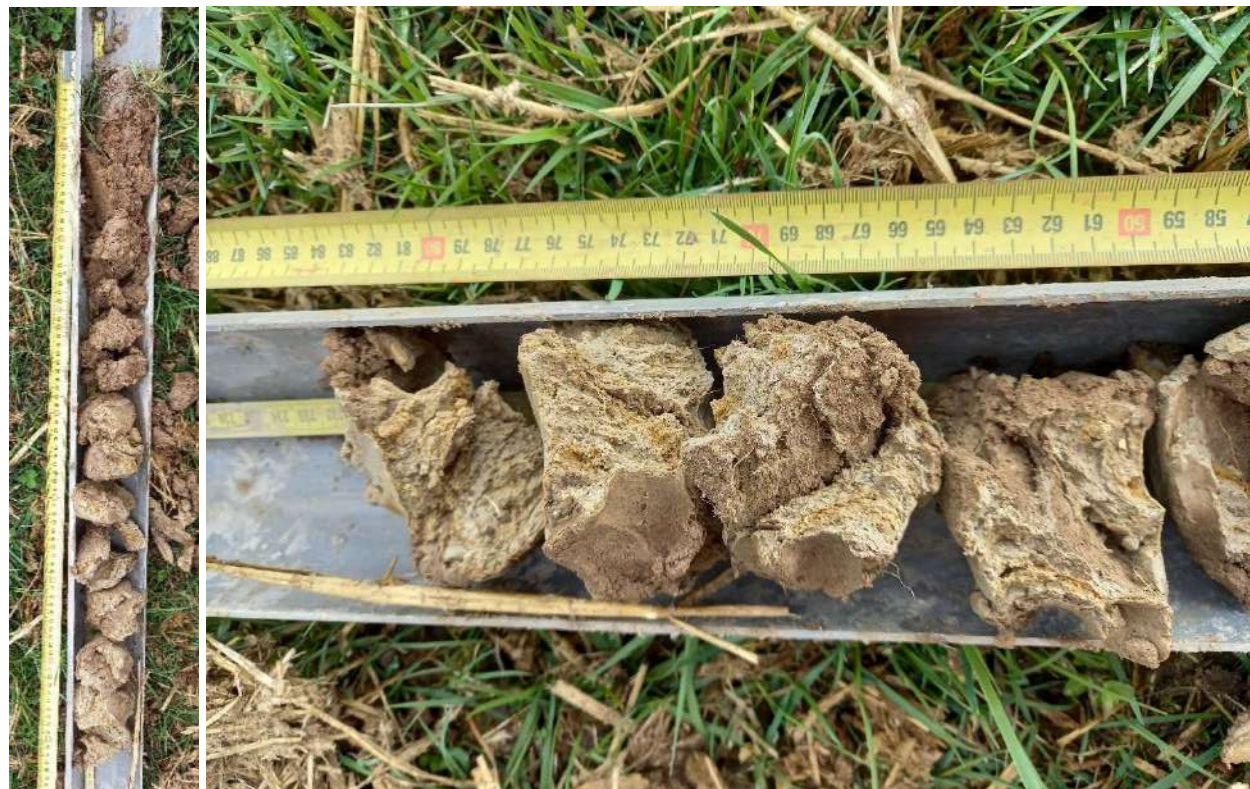
Figure 41 : Sondage n°3, caractéristique du secteur sud : colluviosol recouvert d’une épaisse couche d’argile, ©EODD 2024
