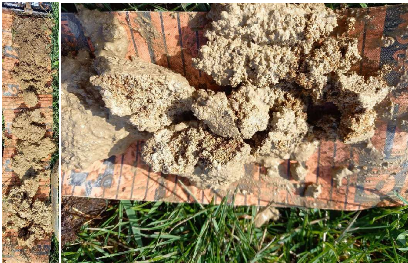
Figure 40 : Sondage n° 19, caractéristique des sondages positifs du secteur nord : Alocrisol avec un peu d’argile, ©EODD 2024
