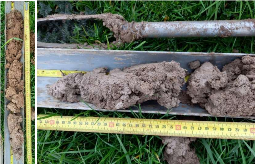
Figure 39 : Sondage n° 12, caractéristique des sondages négatifs du secteur nord : Alocrisol, ©EODD 2024
