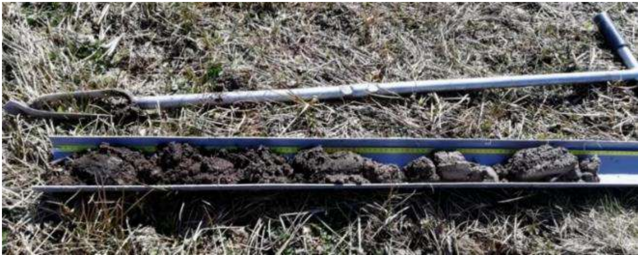
Figure 13 : Exemple de carottage réalisé à la tarière manuelle Edelman (source : EODD, 2022)
