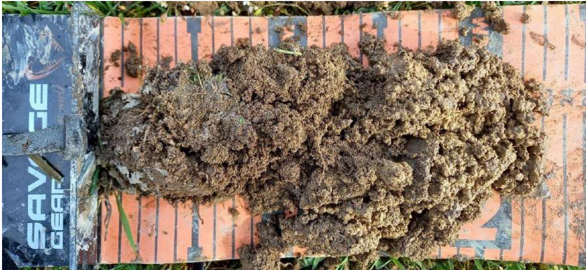
Figure 38 : Sondage n° 15, caractéristique des sondages refus du secteur nord : Alocrisol avec arrêt sur socle rocheux, ©EODD 2024
