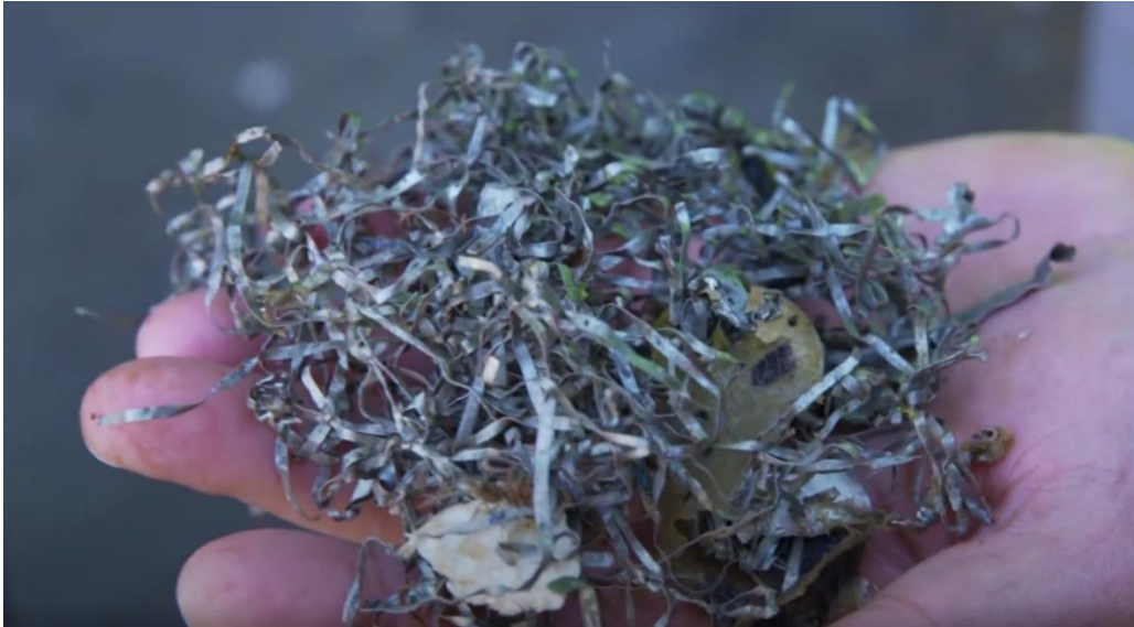
Figure 2 : Fragments résultant du broyage des panneaux avant tri des fractions (source : youtube.com/@soren_eco )
