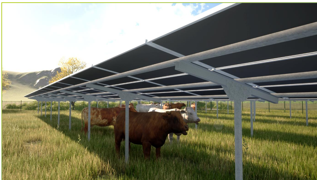
Figure 3 : Photomontage illustrant le principe d'ombrières agrivoltaïques en synergie avec un élevage bovin (Source : Synerdev)
