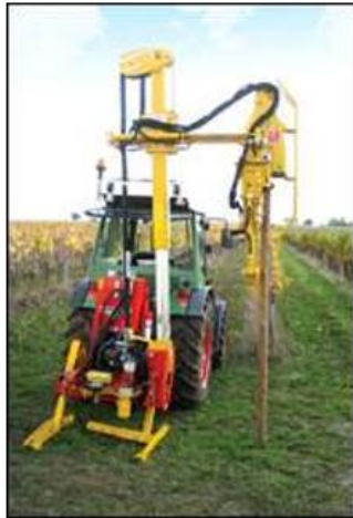
Figure 3 : exemple d'enfonce-pieux – source : Rabaud SARL
