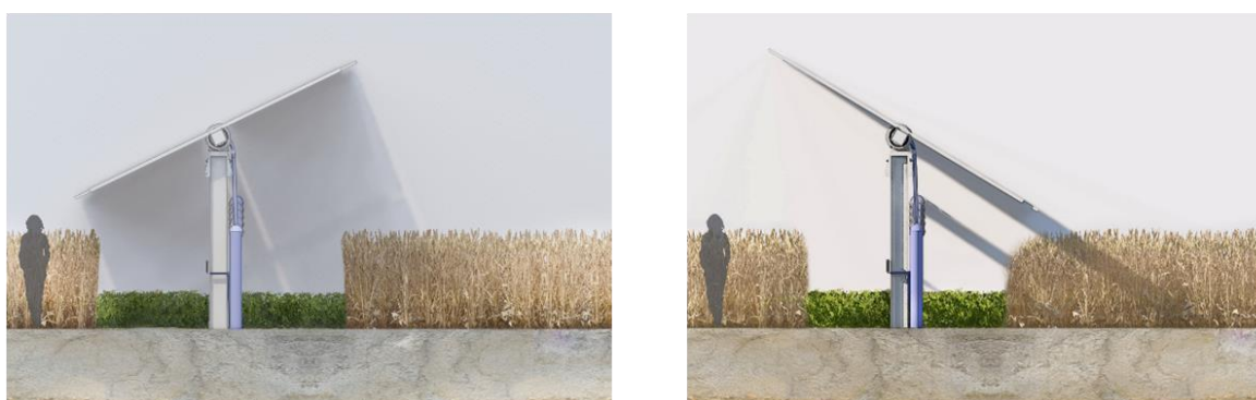
Figure 1 : Schéma de fonctionnement des tracker agrivoltaiques et gestion de l'effacement des panneaux
