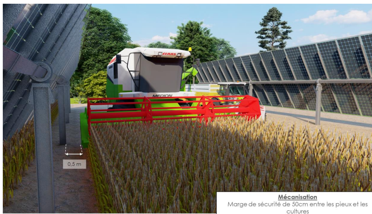
Figure 5 : Implantation des structures photovoltaïques - marge de sécurité par rapport aux trackers
