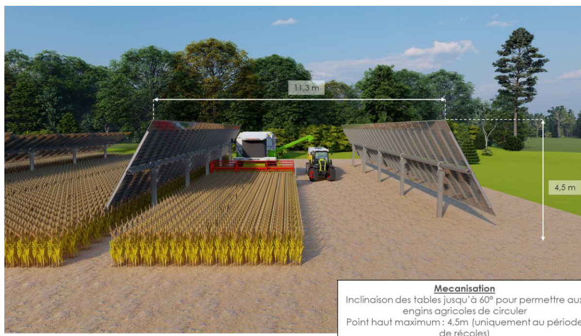
Figure 4 : Implantation des structures photovoltaïques - Inclinaison des tables au moment de la récolte
