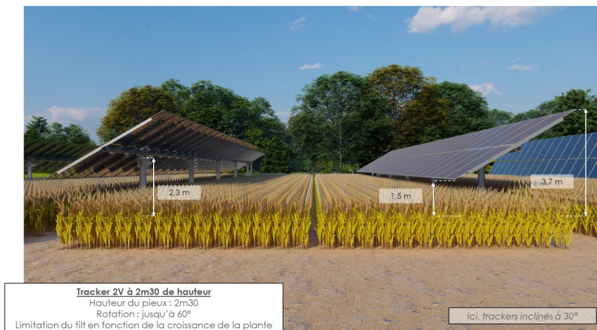
Figure 3 : Implantation des structures photovoltaïques - Bridage des tracker en fonction de la croissance de la plante
