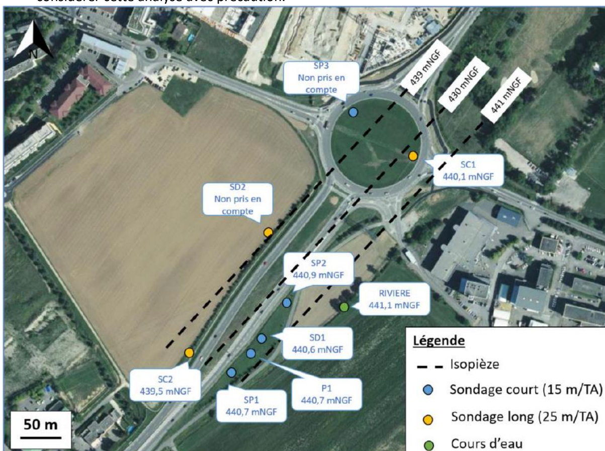
Figure 17 : Esquisse piézométrique au 05/03/2020 (FONDASOL)
