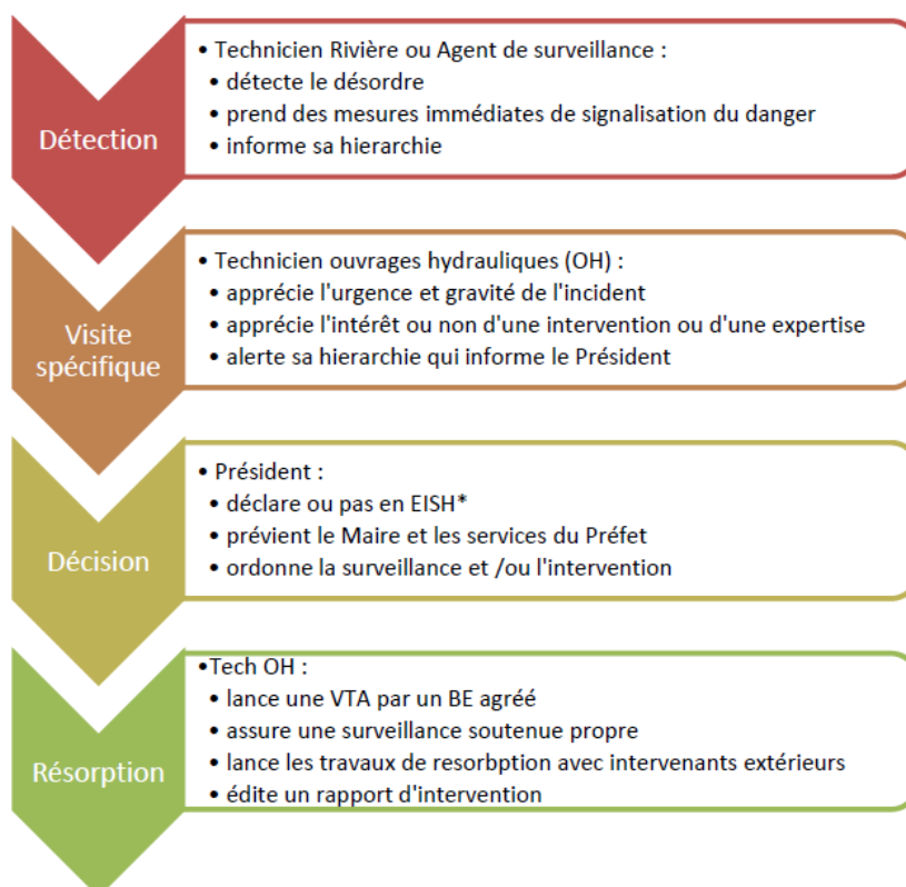
Figure 58 : Organisation d'un désordre détecté sur l'ouvrage
