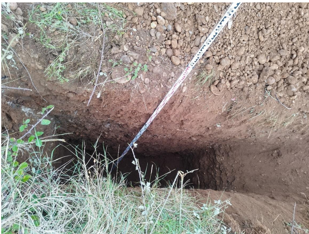
Figure 7 : Sondage à la pelle mécanique
