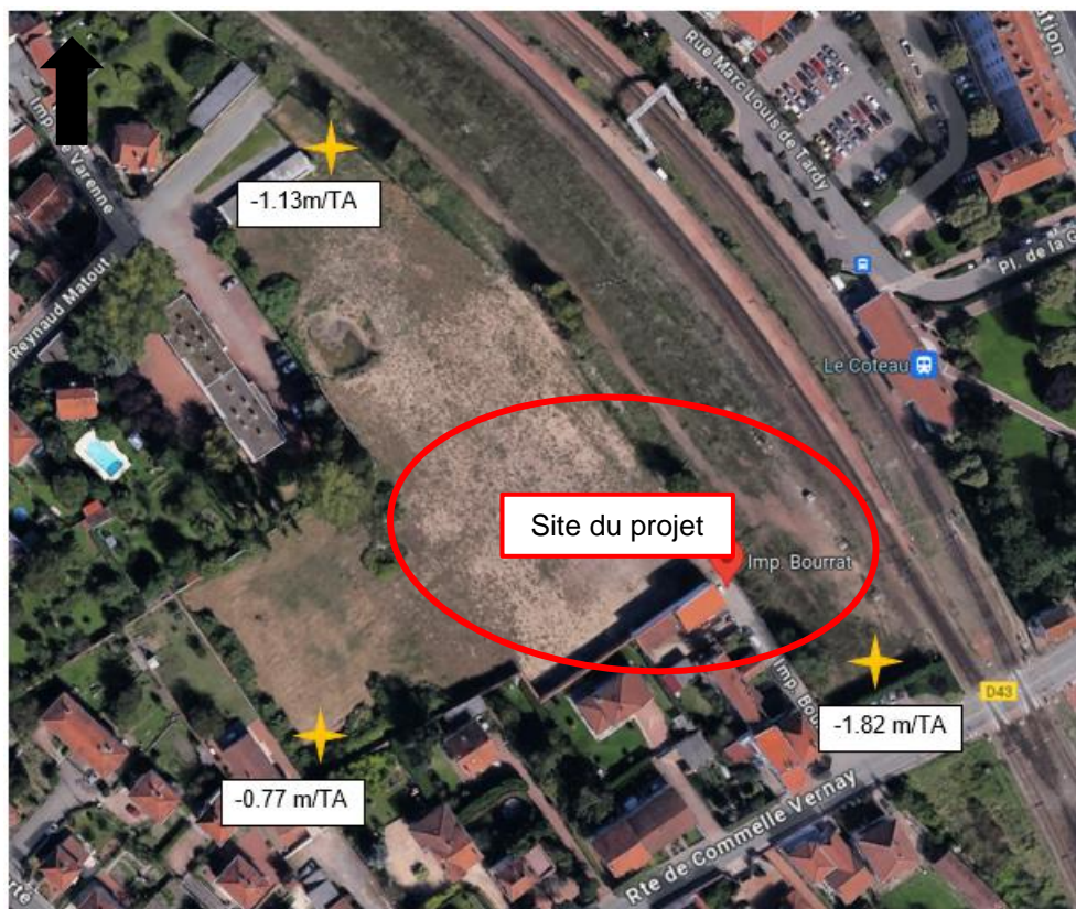
Localisation des piézomètres existants et cotes des eaux souterraines (Source : Rapport G2AVP, GEOTECHNIQUE SAS)
