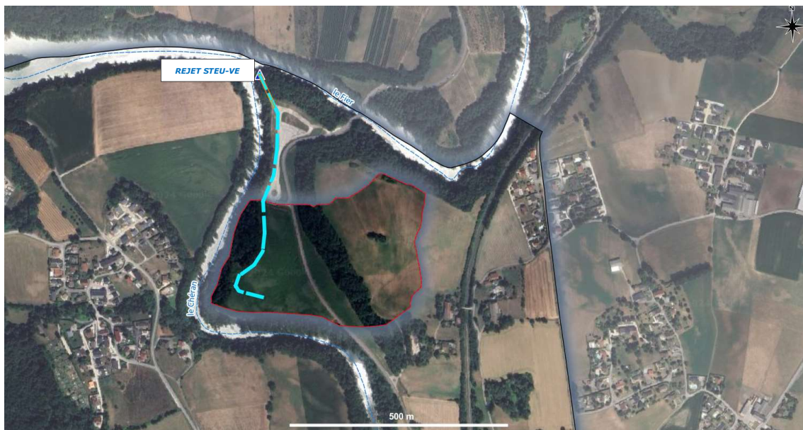
Figure 2-3 : Localisation de la canalisation du point de rejet au Fier des eaux traitées
