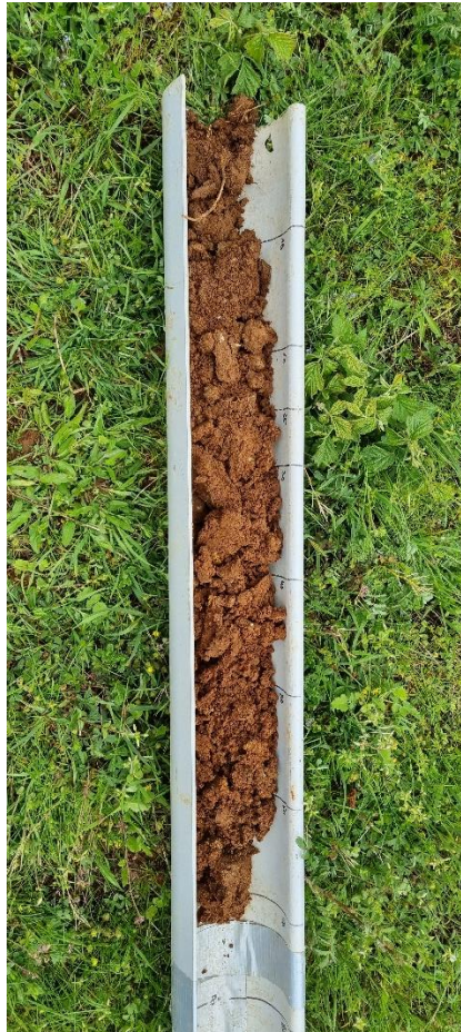
Figure 6 : Sondage le plus au sud, montrant l'absence de traces d'hydromorphie
