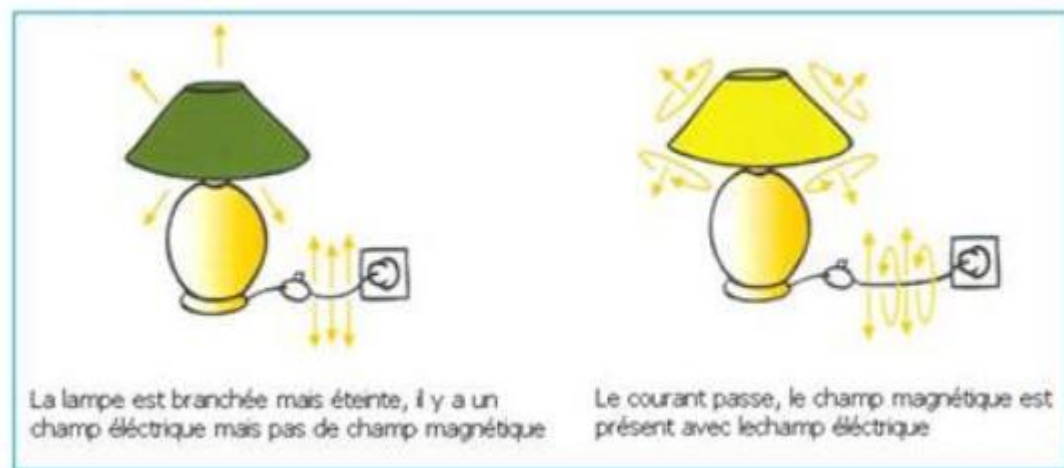
FIGURE 1 : ILLUSTRATION DES CHAMPS ELECTRIQUES ET MAGNETIQUES
