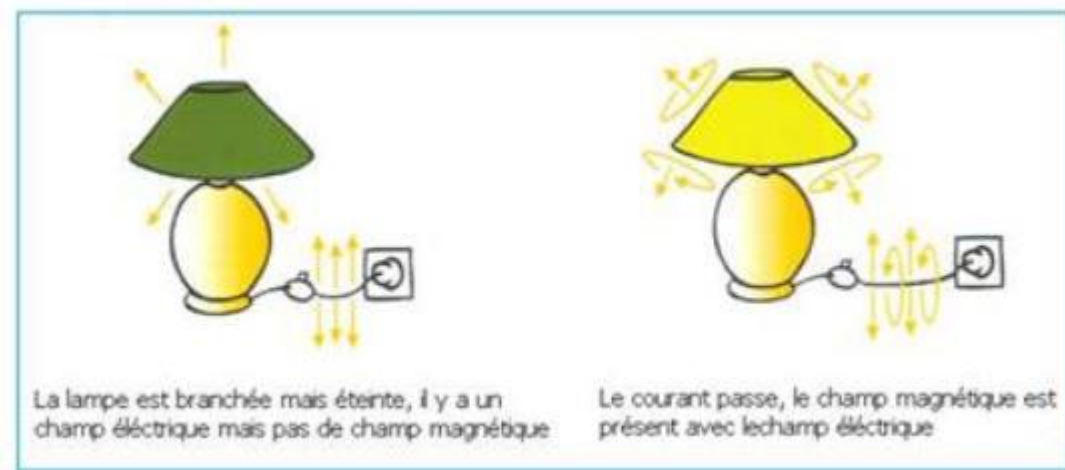
FIGURE 1 : ILLUSTRATION DES CHAMPS ELECTRIQUES ET MAGNETIQUES
