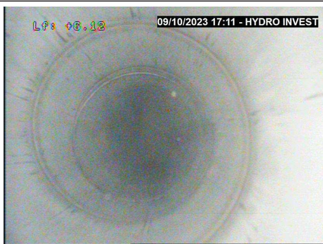
Photo N° 5 – Prof. : 6.1 m/rep – Artésianisme Tube plein inox en parfait état mécanique, quelques traces noirâtres sur la paroi. Eau légèrement trouble, production de sable fin
