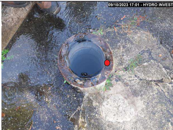
Photo N° 1 Forage en écoulement artésien lors de son ouverture au débit d'environ 3 m 3 /h. Repère des mesures de profondeur = sommet de la bride inox à +0.15 m/sol (point rouge)
