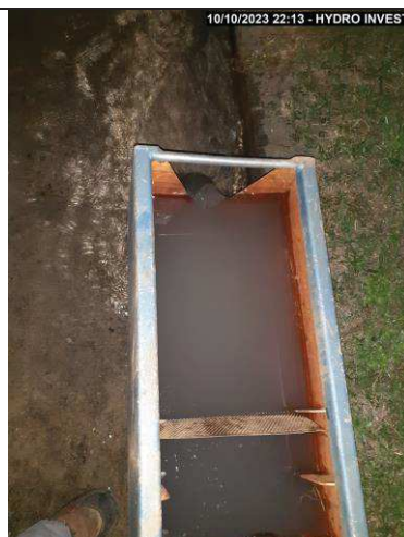
Photo N° 4 Eau trouble lors du palier de pompage au débit d'environ 10 m 3 /h, production de sable fin
