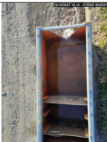
Photo N° 3 Eau claire lors de l'essai de pompage par paliers de débit. Ici au débit de 4 m 3 /h, très faible production de sable fin
