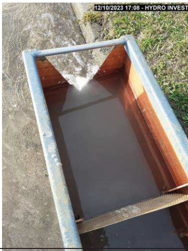
Photo N° 7 En fin de pompage de longue durée, eau légèrement turbide, la production de sable fin à nettement diminuée
