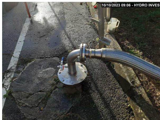
Photo N° 2 Dispositif EIFFAGE ENERGIE installé sur la tête de forage et instrumentation HYDRO INVEST pour contrôle de l'artésianisme
