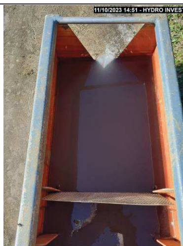
Photo N° 6 Eau trouble, production de sable fin au début du pompage de longue durée au débit d'environ 9 m 3 /h
