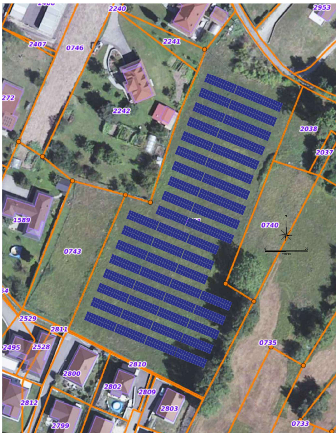
Plan de masse du projet avec position et orientation des tables de panneaux photovoltaïques
