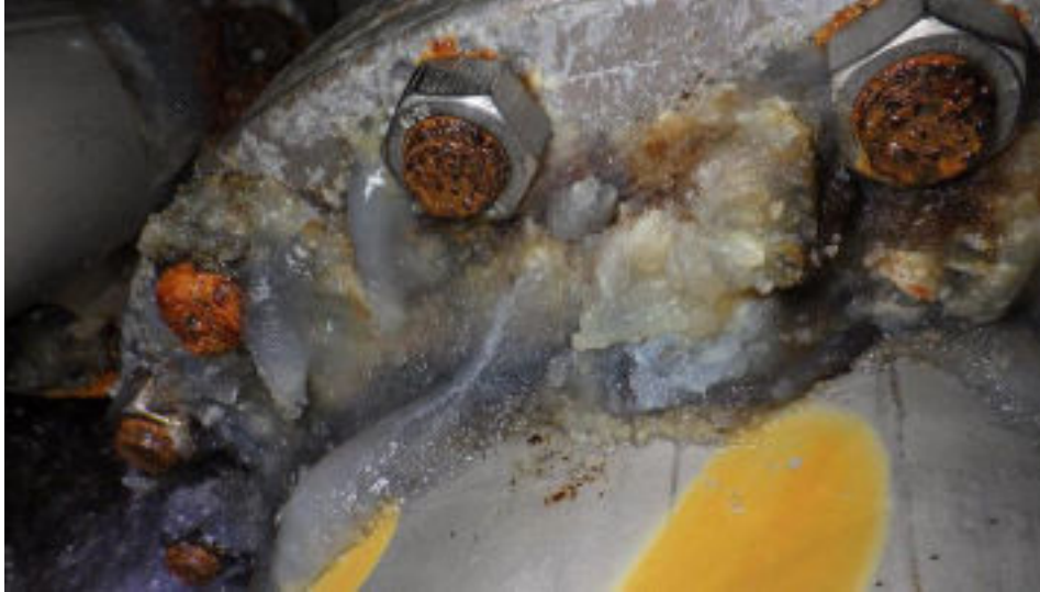
Figure 27. Dépôts sur la tuyauterie du captage au griffon (GSA).
