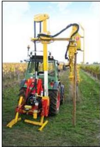
Figure 3 : exemple d'enfonce-pieux – source : Rabaud SARL
