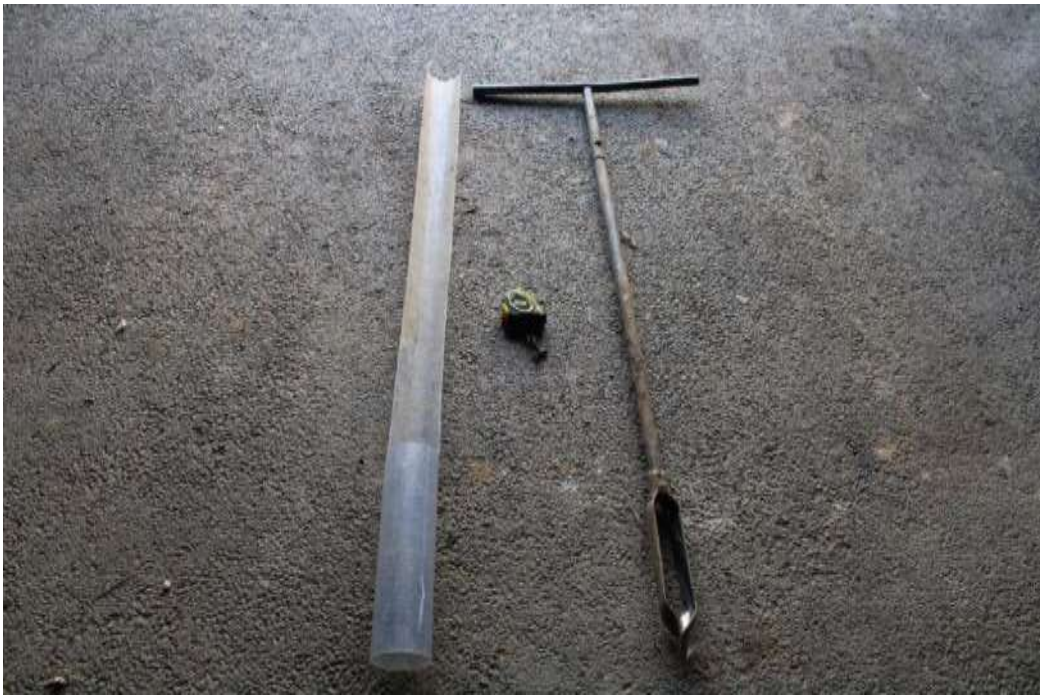
Figure 16 : Photographie du matériel de pédologie (Source : ECR Environnement)
