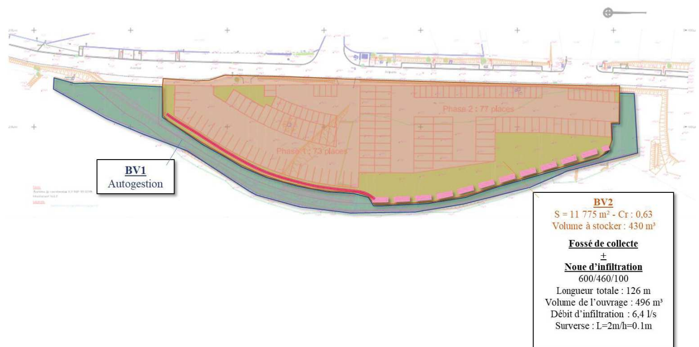
Figure 18 : Schéma de principe de gestion des eaux pluviales (Source : C2i Conseil, 2022)
