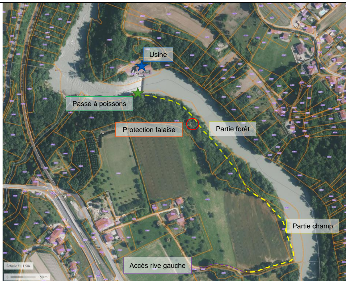
Figure 11 – Vue en plan des différentes natures de la piste d'accès rive gauche
