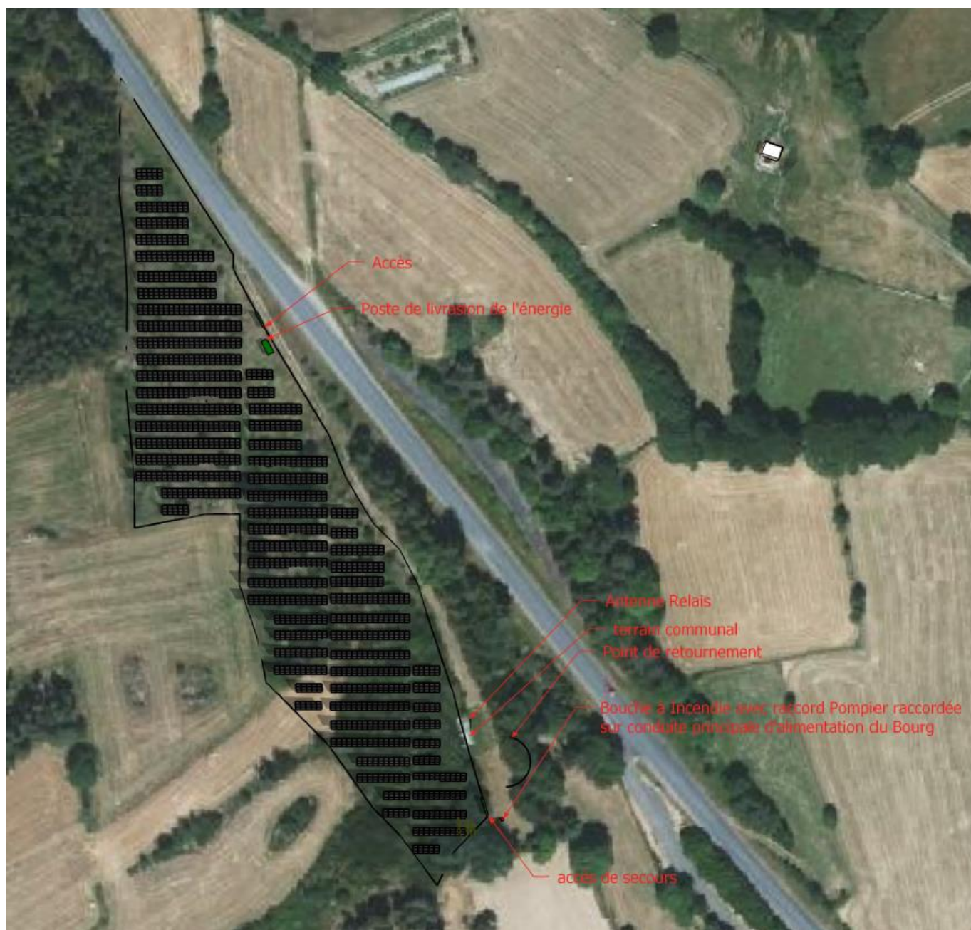
Principe d'implantation des éléments de la centrale photovoltaïque
