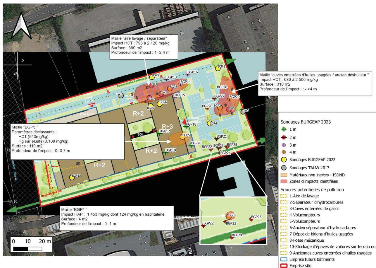
Figure 7 : Localisation des mailles impactées et des matériaux non inertes sur le plan projet
