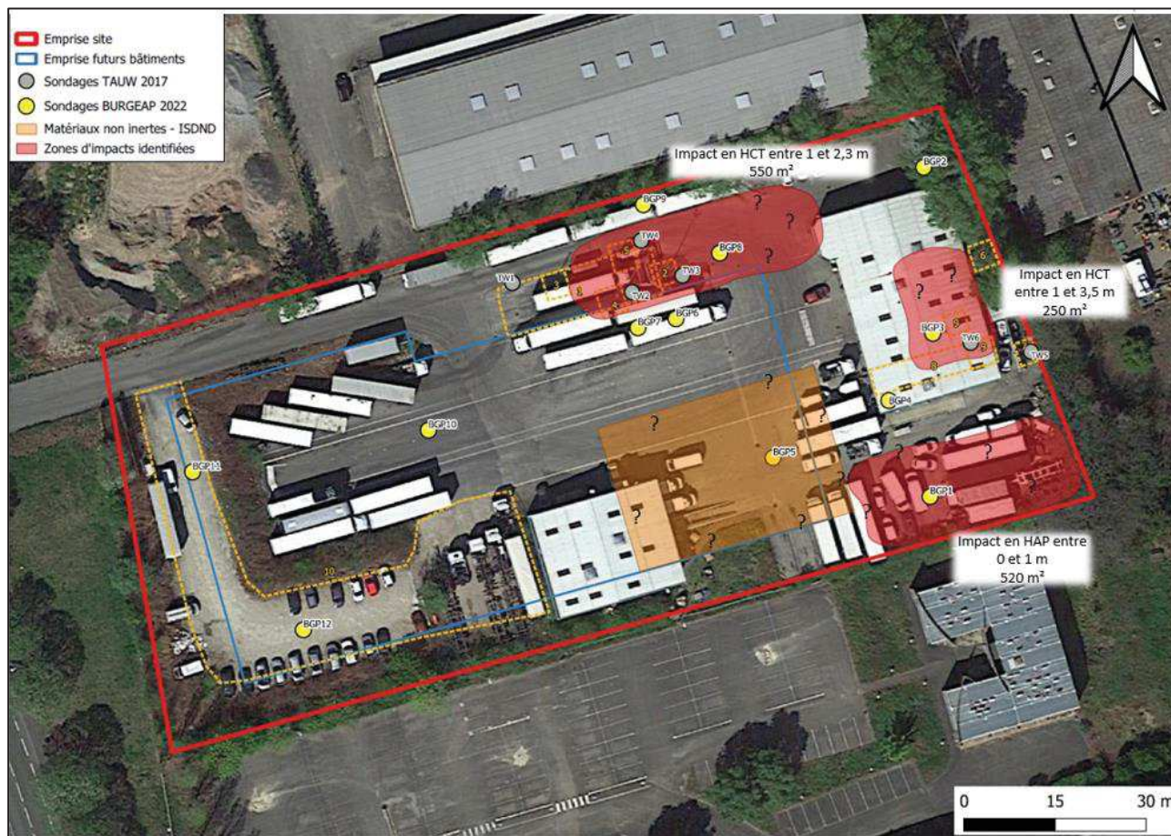
Figure 3 : Localisation des impacts en hydrocarbures et des matériaux non inertes
