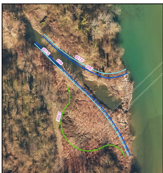
Figure 3 : Emprise de l'ouverture en rive gauche proposée par l'option 1. En bleu foncé, le fond de la lône ; en bleu clair, la ligne d'eau au débit réservé ; en pointillés verts, la cote de berge du nouvel entonnement
