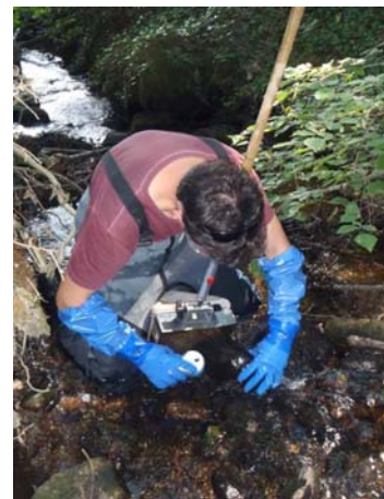
Prélèvement de la macrofaune benthique à l'aide d'un filet Surber
