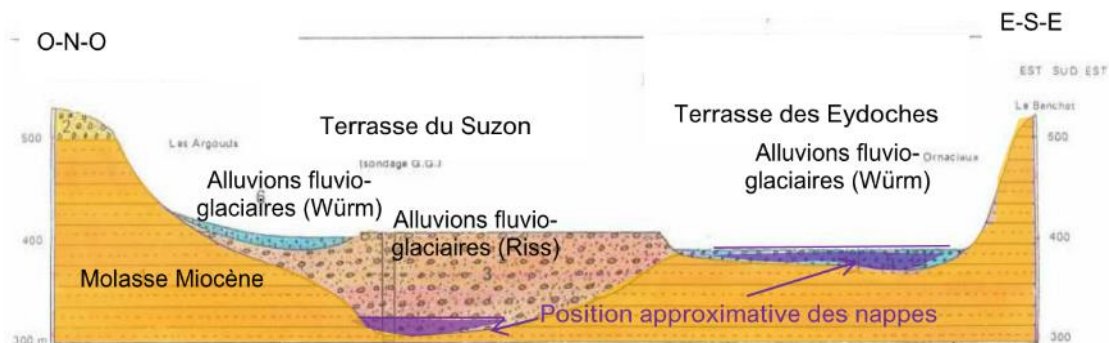
Figure 25 : Coupe hydrogéologique schématique de la plaine du Liers (source : BRGM, 1994)
