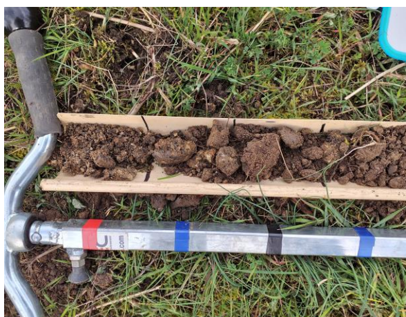
Sol limono-sableux avec présence de briques et de cailloux. Peu d'oxydation
