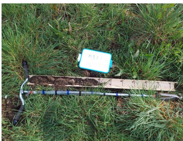
Sondage pédologique dans l'habitat dominant : traces d'oxydations inférieures à 5 %
