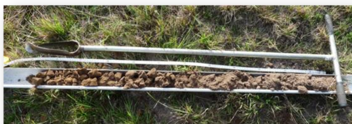
Figure 10 : Sondage pédologique à la tarière manuelle - © Ecosphère
