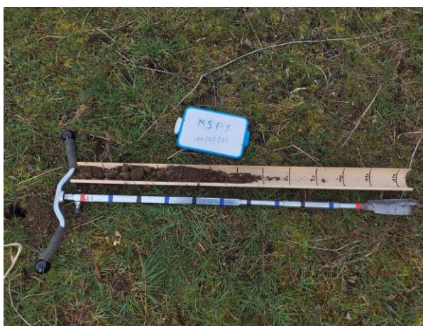
Sondage pédologique sur remblais (espaces verts). Présence d'oxydation à partir de 35 cm mais inférieure à 5 %
